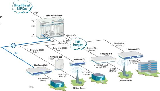
ADTRAN Ethernet Service Access Architecture. Ethernet over Fiber, e.SHDSL, DS1 or DS3.
